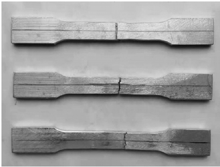
图4 拉伸断裂试样
